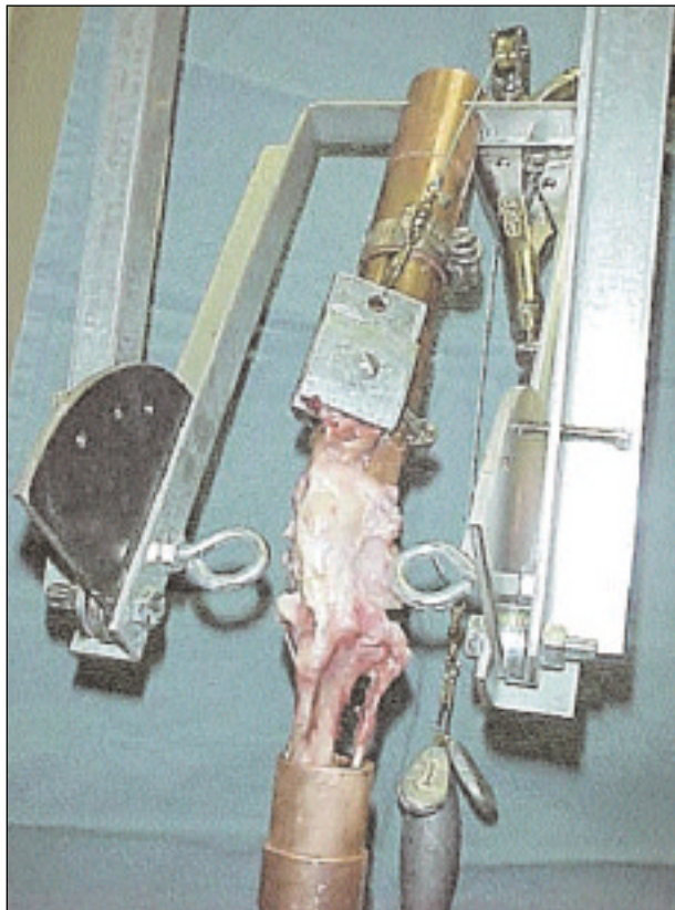
Figura 1: Máquina de Evaluación Universal en donde se fijaron las rodillas para la evaluación.
