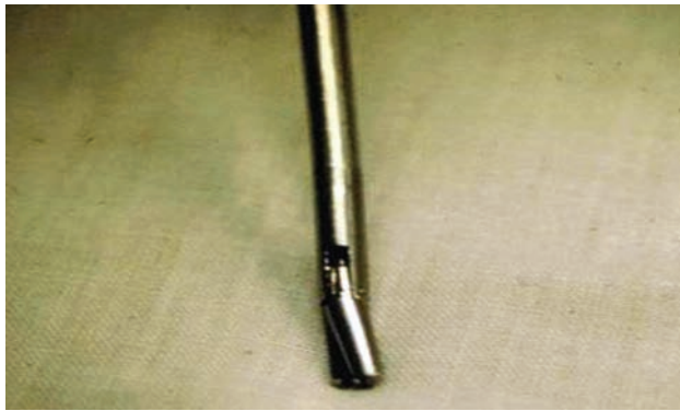
Figura 1: ruptura de pinza Grasper.
